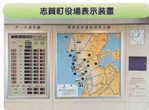
◀表示装置 空間放射線量率などをリアルタイムで表示しています。
